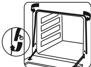
Когда Вы моете плиту внутри, резиновое уплотнение дверцы жарочного электрошкафа лучше снять, вынув металлические скобы из отверстий.
